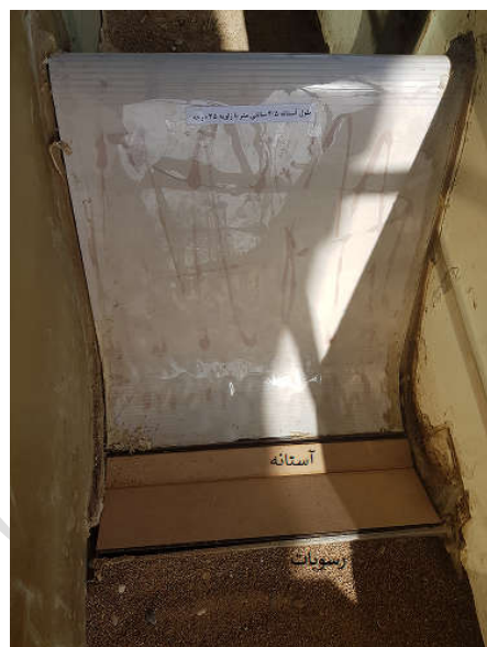
شکل ۳. موقعیت پرتاب‌کننده مثلثی در فلوم آزمایشگاهی و رسوبات در پایین‌دست آن
