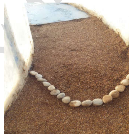
شکل ۴. نمونه ای از سازه w-weir و Cross Wane
