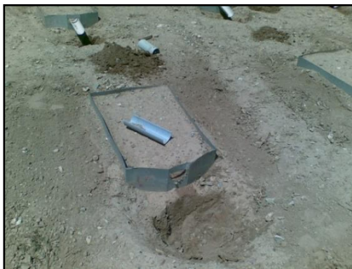
شکل ۲- نمایی از کرت‌های ایجاد شده روی دامنه با شیب ۹ درصد
