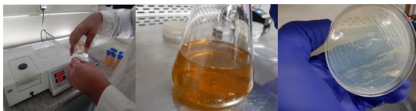
شکل ۲. قرارگیری باکتری‌ها روی محیط کشت و تنظیم میزان غلظت باکتری
