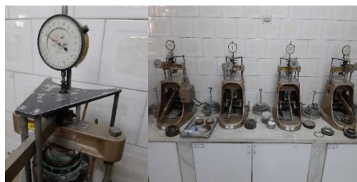
شکل ۴. استفاده از ۴ دستگاه تحکیم به صورت همزمان
