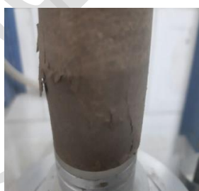
شکل ۵. انجام آزمایش مقاومت فشاری محدود نشده بر روی نمونه خاک رس
