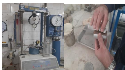
شکل ۵. انجام آزمایش مقاومت فشاری محدود نشده بر روی نمونه خاک رس
