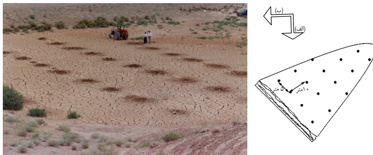
شکل ۲. محل‌های نمونه برداری در مخازن سدها (الف) و نمونه‌ای از مناطق حفر چاهک‌های گمانه‌ای در مخزن سد عمران (ب)
