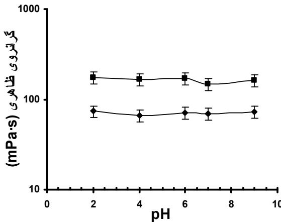
شکل ۶. نمایش تأثیر پ هاش روی گرانزوی ظاهري محلول پودر ثعلب در پ هاش ۷ و دمای ۲۵ درجه سانتي گراد در دو غلظت مختلف (۳، ۵، ۷ گرم در لیتر) و سرعت چرخشی ثابت ۱۰۰ دور بر دقیقه.
