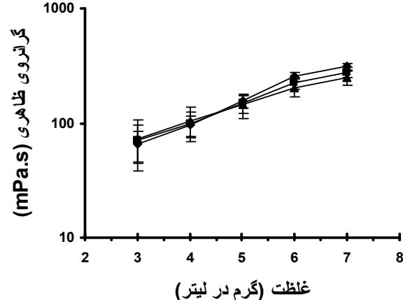
شکل ۵. نمایش تأثیر غلظت روی گرانزوی ظاهري محلول پودر ثعلب در پ هاش ۷ و دمای ۲۵ درجه سانتي گراد در سرعت های چرخشی مختلف (۱۰۰، ۲۵۰، ۷۵۰ دور بر دقیقه).
