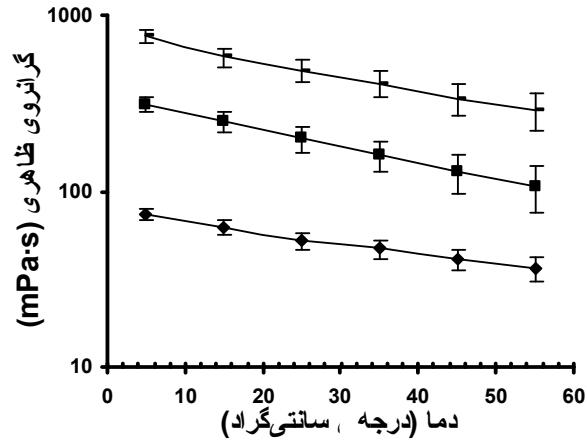
شکل ۴. نمایش تأثیر دما روی گرانزوی ظاهري محلول پودر ثعلب در پ هاش ۷ و دمای ۲۵ درجه سانتي گراد در غلظت های مختلف (۳، ۵، ۷ گرم در لیتر) و سرعت چرخشی ثابت ۵۰ دور بر دقیقه
