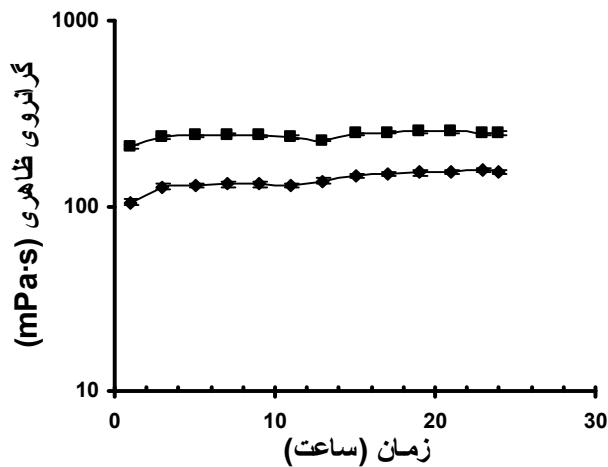
شکل ۱. تأثیر مدت زمان جذب آب روی گرانروی ظاهری محلول پودر ثعلب در بافر پ هاش ۷ و دمای ۲۵ درجه در دو غلظت  $\bullet$ ؛  $\square$ ؛ ۳ و ۵ گرم در لیتر اندازه‌گیری شده در سرعت چرخشی ثابت  $50^{\circ}$  دور بر دقیقه.
