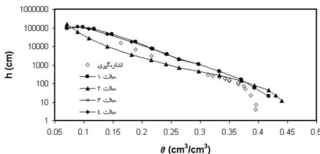
شکل ۲. منحنی مشخصه آب خاک برای چهار حالت مختلف و مقایسه با منحنی اندازه‌گیری شده در خاک شماره ۹ (باft لوم)
