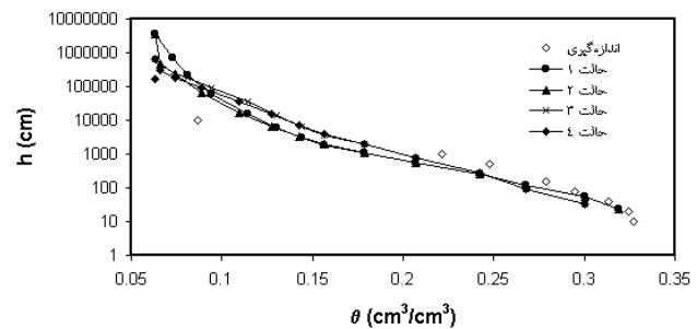
شکل ۵. منحنی مشخصه آب خاک برای چهار حالت مختلف و مقایسه با منحنی اندازه‌گیری شده در خاک شماره ۱۶ (باft لوم شن)
