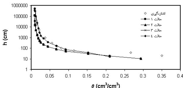
شکل ۶. منحنی مشخصه آب خاک برای چهار حالت مختلف و مقایسه با منحنی اندازه‌گیری شده در خاک شماره ۱۸ (باft شن)
