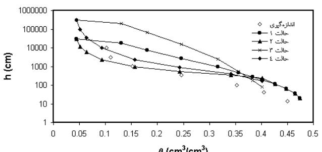
شکل ۳. منحنی مشخصه آب خاک برای چهار حالت مختلف و مقایسه با منحنی اندازه‌گیری شده در خاک شماره ۱۲ (باft سیلت لوم با مقدار سیلت بیشتر از ۶۰ درصد)
