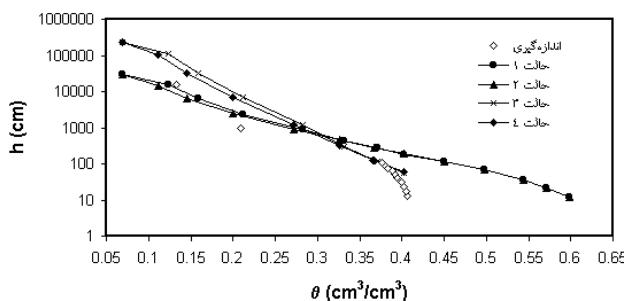
شکل ۴. منحنی مشخصه آب خاک برای چهار حالت مختلف و مقایسه با منحنی اندازه‌گیری شده در خاک شماره ۱۵ (باft سیلت لوم با مقدار سیلت کمتر از ۶۰ درصد)
