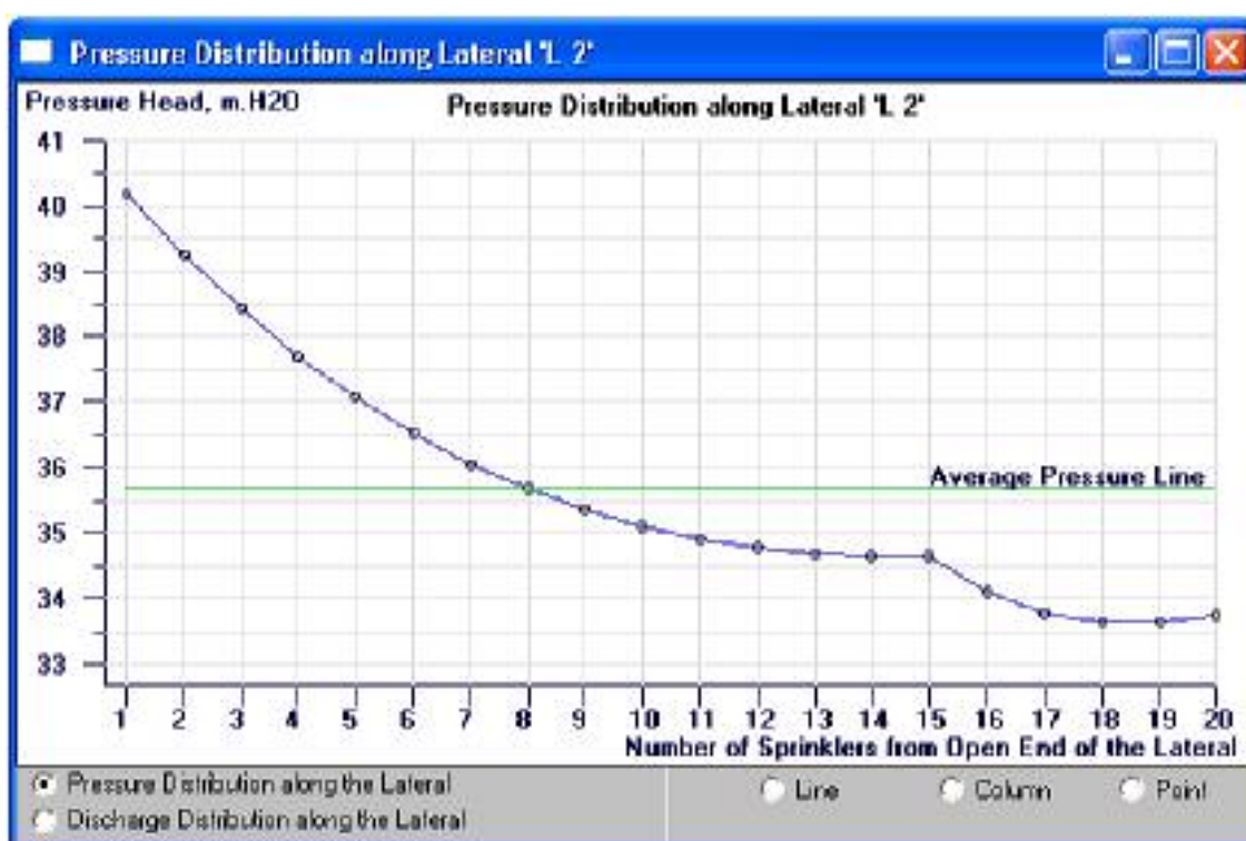
شکل ۴. نمودار مقادیر فشار آبیاری‌های لوله فرعی با آبیاری‌های ثابت با شیب ۱- درصد و با دو قطر مختلف
