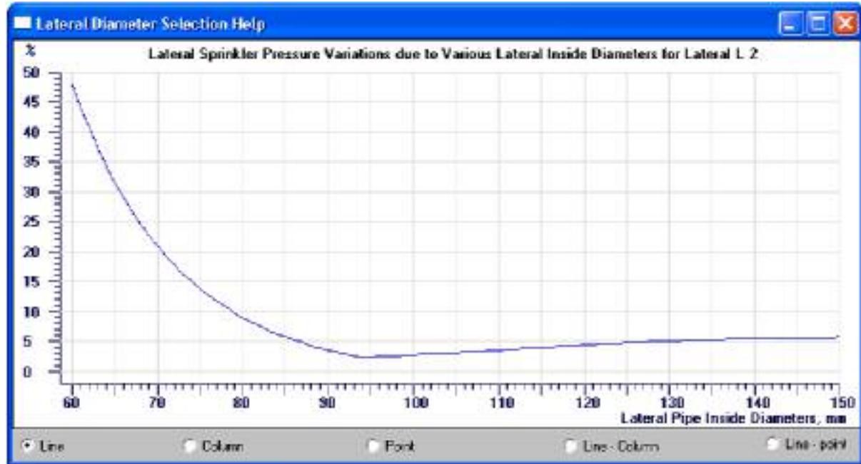
شکل ۲. نمودار درصد تغییرات فشار به ازای قطرهای داخلی مختلف لوله فرعی با آپیاش‌های ثابت با شیب ۱- درصد
