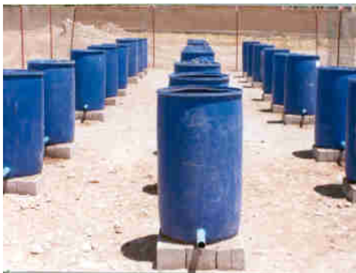
شکل ۱. مجموعه لایسیمتراهای کارگذاری شده در مزرعه
