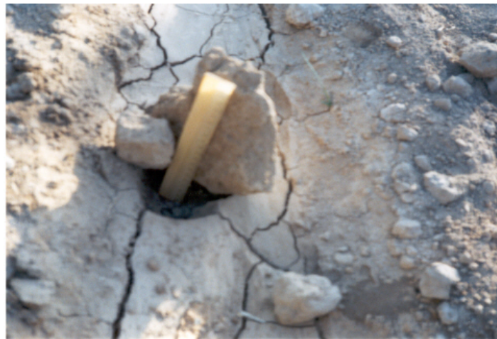
شکل ۵. وجود درز و شکاف در مزرعه مورد آزمایش پس از آبیاری اول
