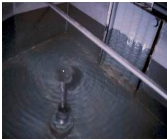
شکل ۸. مدل درحال آزمایش و گرداب تشکیلی
