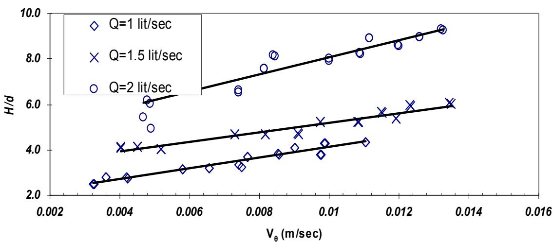
شکل ۱۲. تغییرات نسبت استغراق ( $H/d$ ) در برابر سرعت مماسی جریان تقرب  $V_\theta$  برای آبگیر با قطر  $d=38\text{ mm}$
