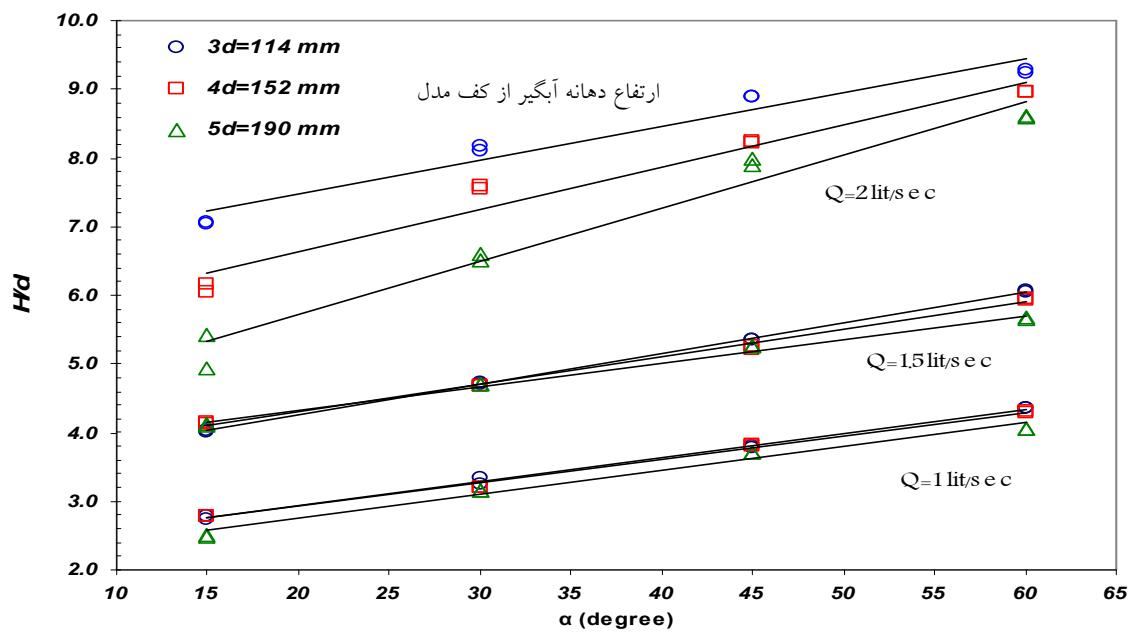
شکل ۹. نمودار تغییرات نسبت استغراق ( $H/d$ ) در برابر تغییر زاویه جریان تقرب  $\alpha$  در لوله آبگیر به قطر  $d=38 \text{ mm}$  و دبی  $1 \text{ lit/sec}$  و  $2 \text{ lit/sec}$  و  $1/5 \text{ lit/sec}$
