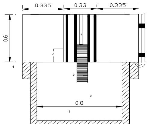
۱- کanal پایین دست مدل ۲- لوله آبگیر ۳- تبدیل ۴- پره‌های عمودی ۵- پیزومتر ۶- پایه‌های مدل
