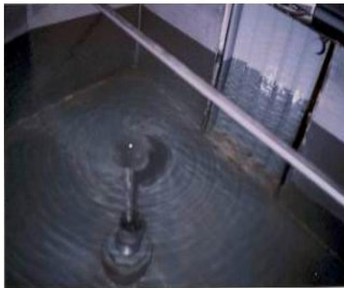
شکل ۸. مدل درحال آزمایش و گرداب تشکیلی
