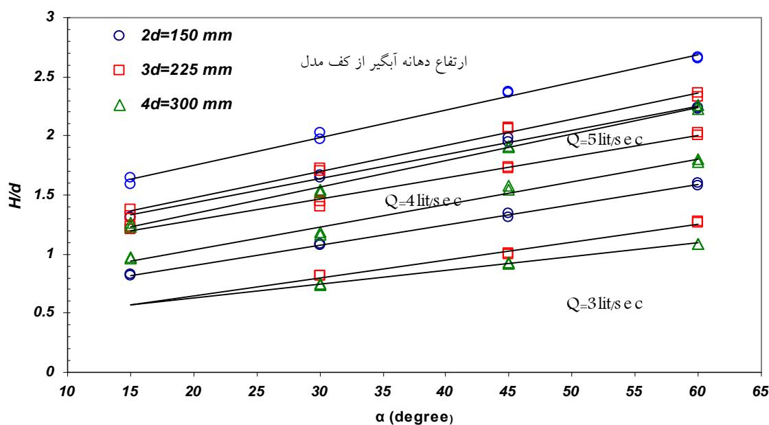
شکل ۱۱. نمودار تغییرات نسبت استغراق ( $H/d$ ) در برابر تغییر زاویه جریان تقرب  $\alpha$  در لوله آبگیر به قطر  $d=75\text{ mm}$  و  $5\text{ lit/sec}$ ,  $4\text{ lit/sec}$ ,  $3\text{ lit/sec}$  دبی
