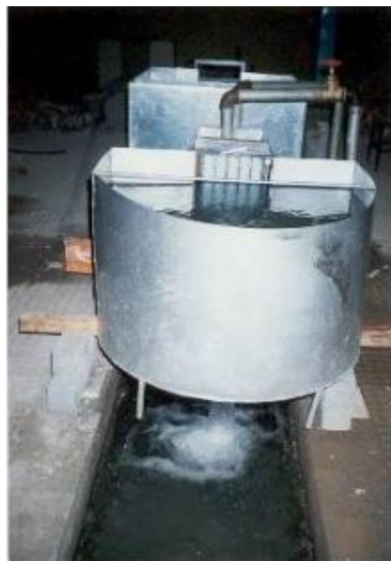
شکل ۷. مدل آزمایشگاهی با سیستم انتقال آب در حال آزمایش
