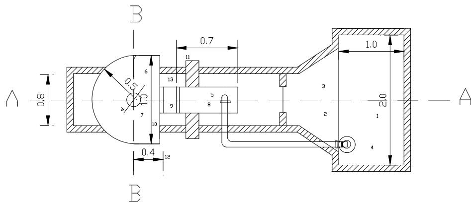
۱- منبع ذخیره آب ۲- سریز مثلثی ۳- کanal پایین دست مدل ۴- پمپ ۵- کanal تقریب مدل ۶- حوضچه آبگیر مدل ۷- لوله آبگیر
