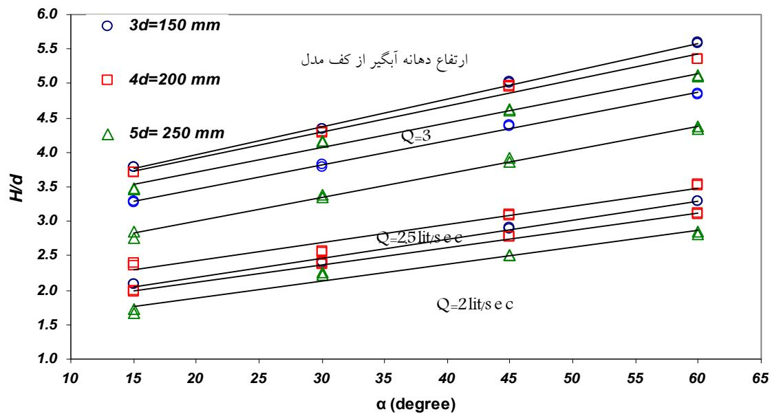
شکل ۱۰. نمودار تغییرات نسبت استغراق ( $H/d$ ) در برابر تغییر زاویه جریان تقرب  $\alpha$  در لوله آبگیر به قطر  $d=50 \text{ mm}$  و دبی  $2 \text{ lit/sec}$  و  $2.5 \text{ lit/sec}$  و  $3 \text{ lit/sec}$
