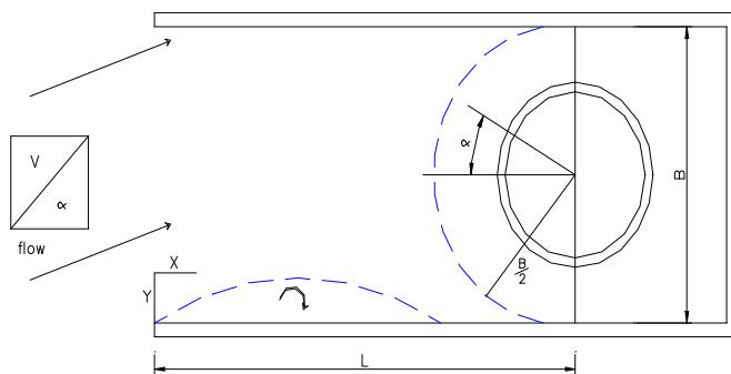
شکل ۱. شماتی آبگیر قائم همراه با کanal مسدود (۷)
