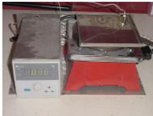
شکل ۱. دستگاه اندازه‌گیری دمای نقطه چسبندگی
