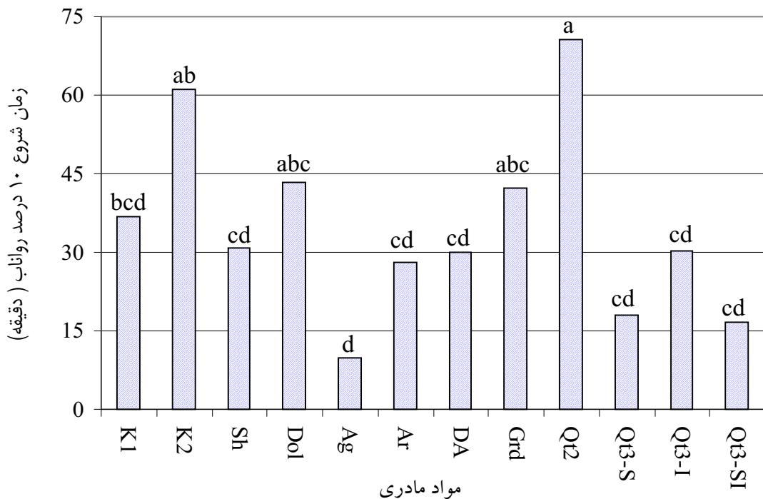
شکل ۵. زمان تبدیل ۱۰ دقیقه در رواناب با ماده مادری گوناگون. حروف متفاوت، اختلافات معنی‌دار را در سطح یک درصد آماری بر اساس آزمون دانکن نشان می‌دهند.
