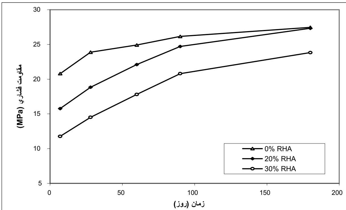
شکل ۶. تأثیر زمان بر روند مقاومت فشاری بتن ساخته شده با درصد های مختلف خاکستر پوسته شلتوك جای گزین در محلول سولفات کلسیم
