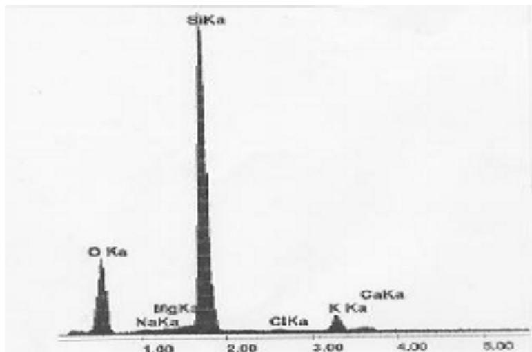
شکل ۳. نقطه اوج مربوط به خاکستر پوسته شلتوك، استخراج شده به وسیله میکروسکوپ الکترونی
