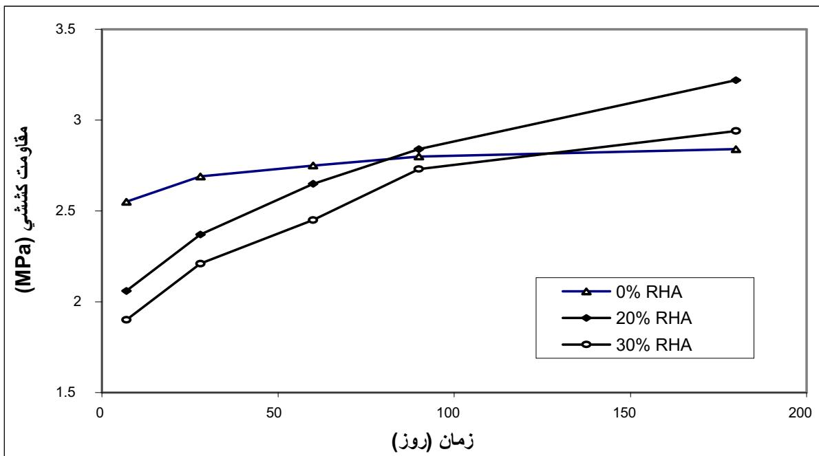
شکل ۸. تأثیر زمان بر روند مقاومت کششی بتن ساخته شده با درصدهای مختلف خاکستر پوسته شلتوك جای گزین در محلول سولفات سدیم
