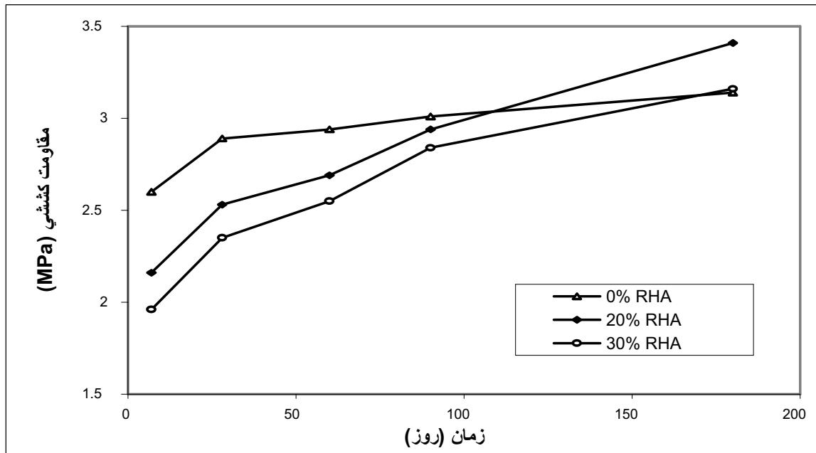
شکل ۹. تأثیر زمان بر روند مقاومت کششی بتن ساخته شده با درصدهای مختلف خاکستر پوسته شلتوك جای گزین در محلول سولفات کلسیم
