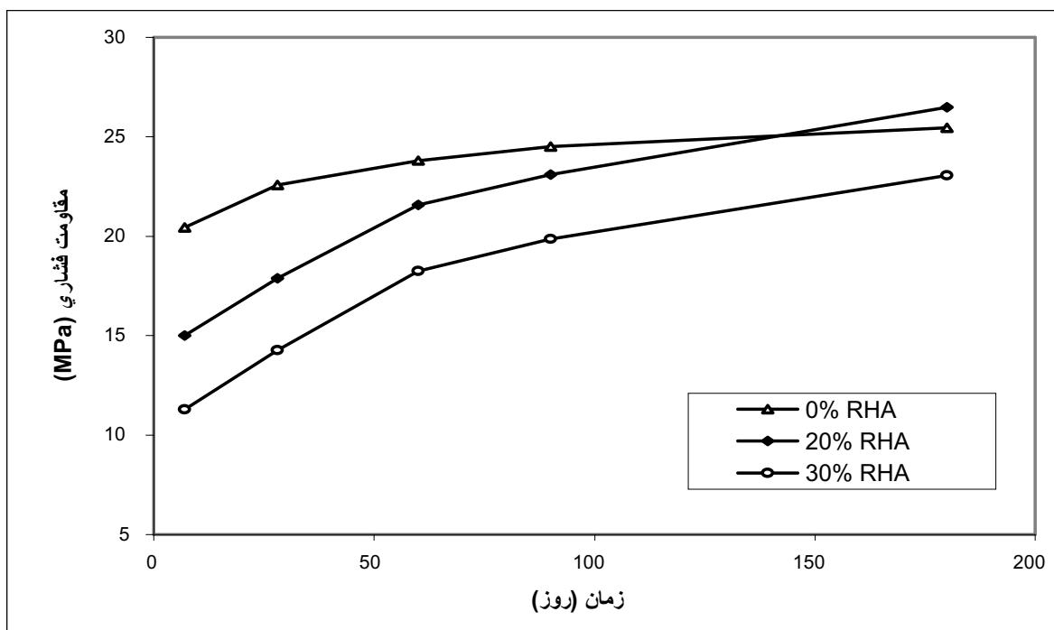
شکل ۵. تأثیر زمان بر روند مقاومت فشاری بتن ساخته شده با درصدهای مختلف خاکستر پوسته شلتوك جایگزین در محلول سولفات سدیم
