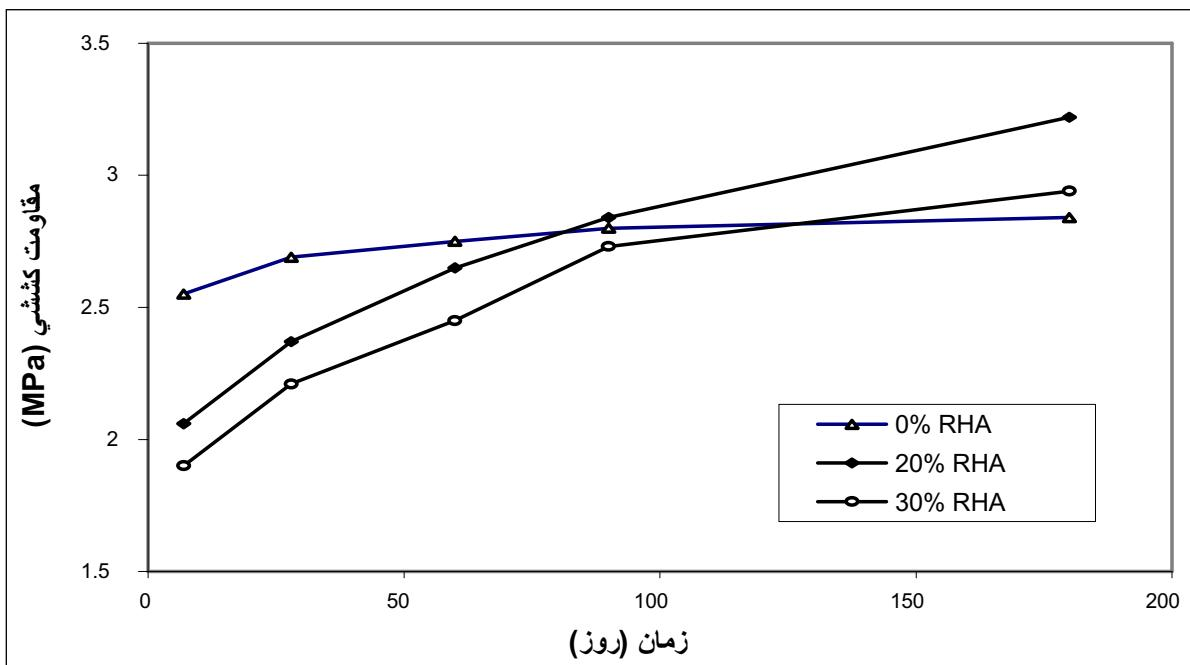
شکل ۷. تأثیر زمان بر روند مقاومت کششی بتن ساخته شده با درصدهای مختلف خاکستر پوسته شلتوك جای گزین در محلول سولفات منیزیم
