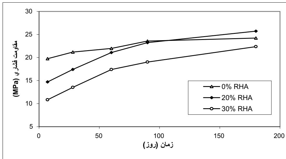
شکل ۴. تأثیر زمان بر روند مقاومت فشاری بتن ساخته شده با درصدهای مختلف خاکستر پوسته شلتوك جایگزین در محلول سولفات منیزیم
