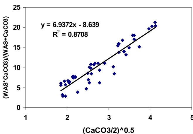
شکل ۷. نمودار رگرسیون خطی (پس از تبدیل متغیرها) یک متغیره رابطه WAS با آهک ( $\text{CaCO}_3$ )
