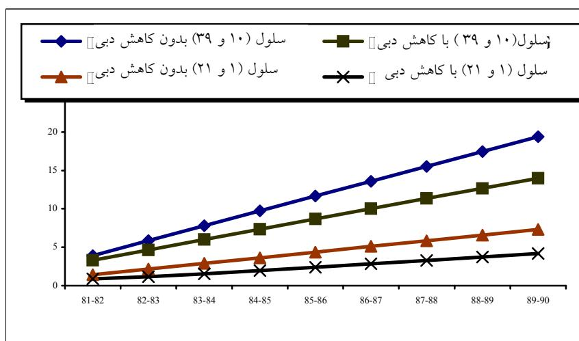
شکل ۸. روند افت در سلوهای (۱۰ و ۳۹) و (۱ و ۲۱) در دو حالت با کاهش دبی و بدون کاهش دبی
