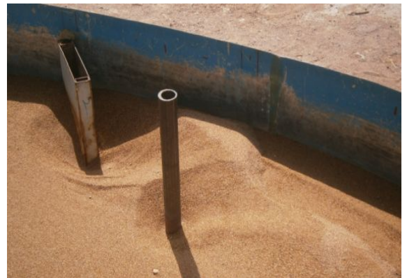
شکل ۸. پایه پل و آبشکن جاذب در دبی ۵۱ لیتر بر ثانیه - الگوی آبستگی در اطراف پایه و آبشکن
