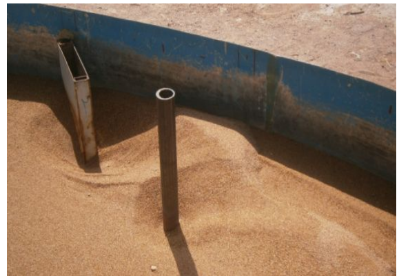
شکل ۸. پایه پل و آبشکن جاذب در دبی ۵۱ لیتر بر ثانیه - الگوی آبستنگی در اطراف پایه و آبشکن
