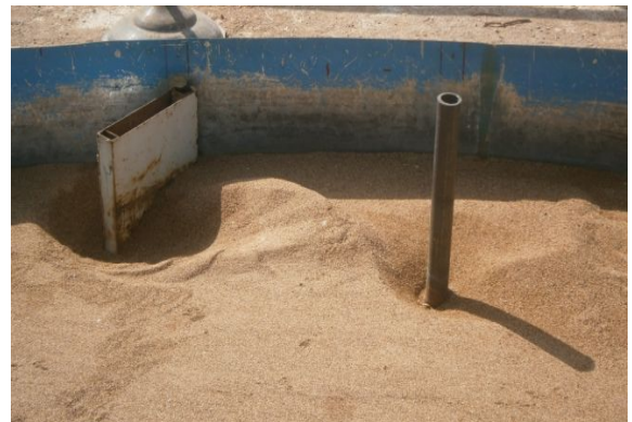
شکل ۷. پایه پل و آبشکن دافع در دبی ۴۹ لیتر بر ثانیه - الگوی آبستنگی در اطراف پایه و آبشکن
