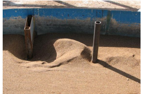
شکل ۶. پایه پل و آبشکن عمودی در دبی ۴۷ لیتر بر ثانیه - الگوی آبستنگی در اطراف پایه و آبشکن
