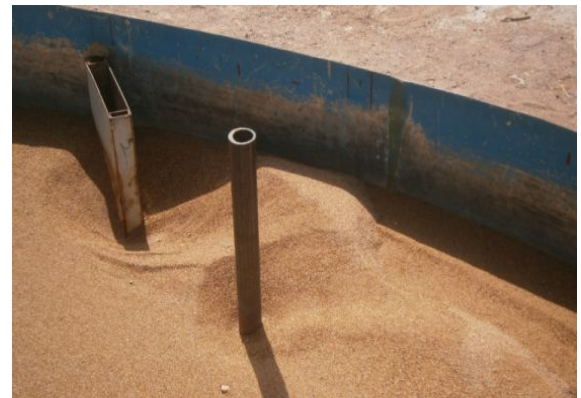
شکل ۸. پایه پل و آبشکن جاذب در دبی ۵۱ لیتر بر ثانیه - الگوی آبستنگی در اطراف پایه و آبشکن
