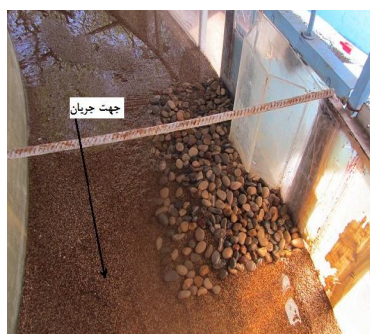
شکل ۴. تکیه گاهها و سنگ چین اطراف آن بعد از آزمایش
