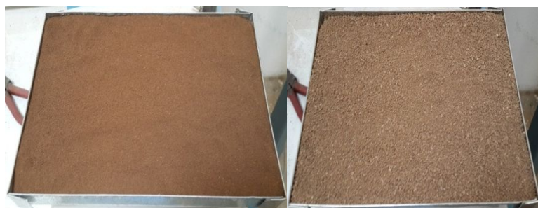
شکل ۲. نمونه‌های تهیه شده در اندازه‌های گوناگون درون سینی مخصوص جهت قرارگیری در دستگاه تونل باد
