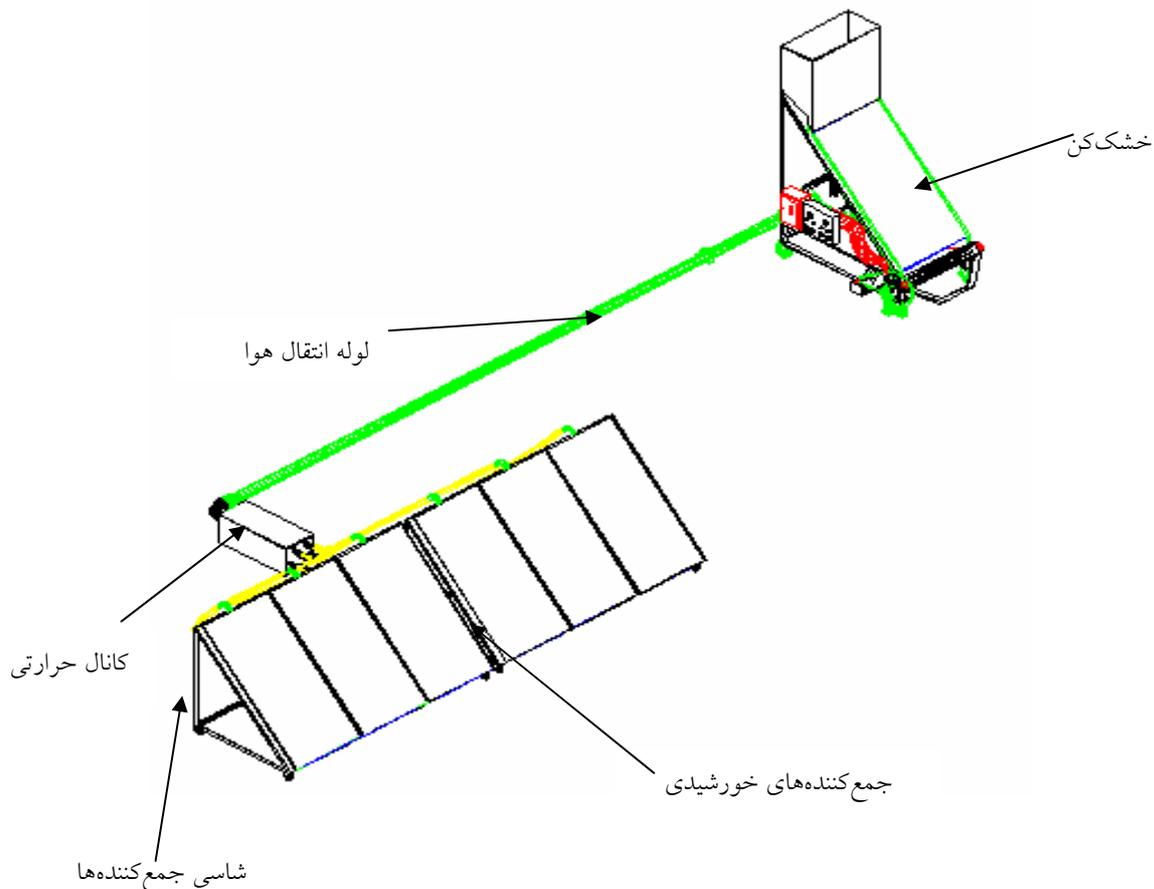
شکل ۱. طرحواره‌ای از مجموعه دستگاه خشک‌کن
