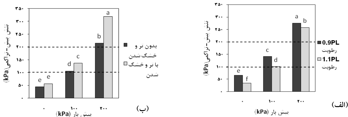
شکل ۴. الف) اثر متقابل رطوبت و بار متراکم‌کننده و ب) اثر متقابل تروخشک شدن و بار متراکم‌کننده بر تنش پیش-تراکمی در آزمایش PST (تعیین شده به روش کاساگراند). میانگین‌های دارای حروف مشابه، از نظر آماری تفاوت معنی‌داری در سطح احتمال ۵٪ براساس آزمون LSD ندارند.
