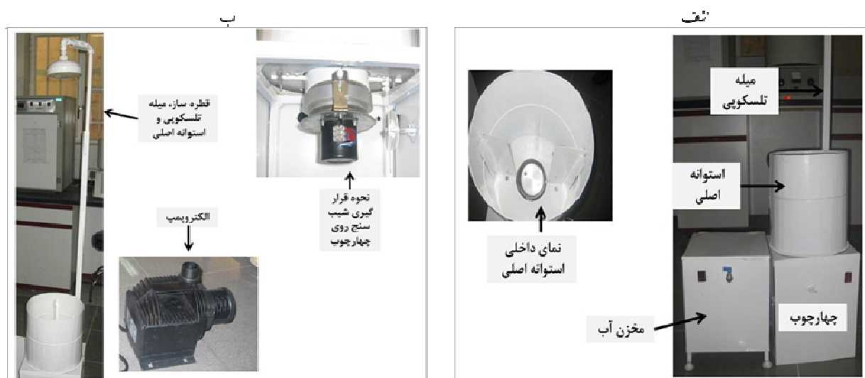
شکل ۱. دستگاه پاشمانی چندمتغیره، الف: میله تلسکوپی، چهارچوب، استوانه اصلی و نمای داخلی از نحوه قرارگیری استوانه نمونه‌گیری در داخل استوانه اصلی، ب: الکتروپمپ، قطره‌ساز میله تلسکوپی و استوانه اصلی و نحوه قرارگیری شیب‌سنج روی چهارچوب
