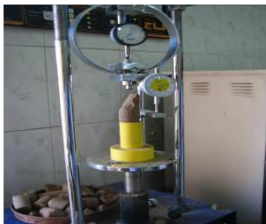
ب) دستگاه آزمایش تک محوری
