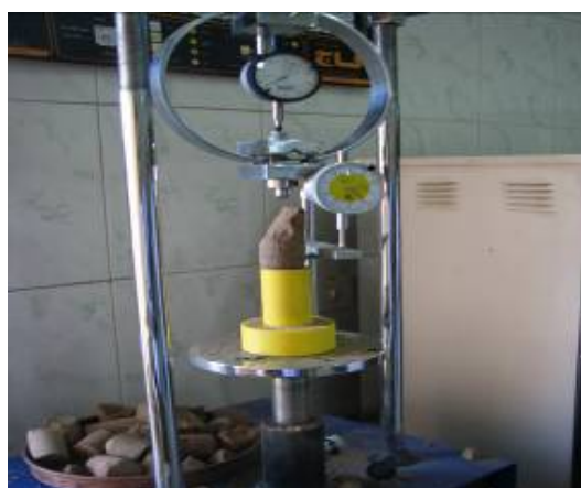
ب) دستگاه آزمایش تک محوری
