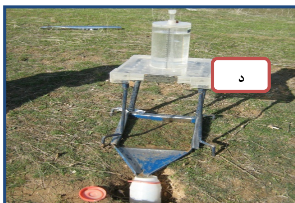
شکل ۱. مراحل مختلف نمونه برداری: شناسایی محل نصب پلات (الف)، مستقر نمودن پلات (ب)، نصب باران ساز بر روی پلات (ج) و انجام نمونه برداری و برداشت روان آب و رسوب (د).
