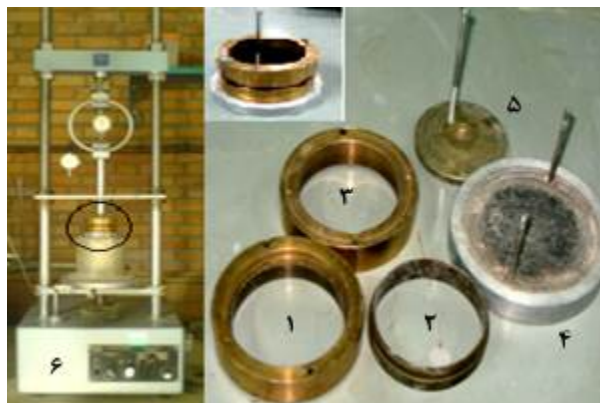
شکل ۱. قالب تراکم مورد استفاده جهت ساخت نمونه‌ها
