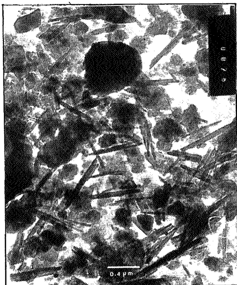
تصویر ۲- الکترون میکروگراف نمونه رس افق تحت الارض سری چغاگلان
