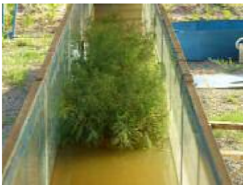
شکل ۲. قرارگیری گیاه گز رودخانه‌ای در فلوم آزمایشگاهی با آرایش و تراکم طبیعی
