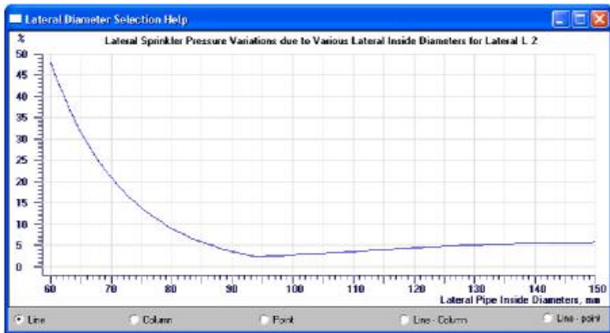
شکل ۲. نمودار درصد تغییرات فشار به ازای قطرهای داخلی مختلف لوله فرعی با آبپاش‌های ثابت با شیب ۱- درصد
