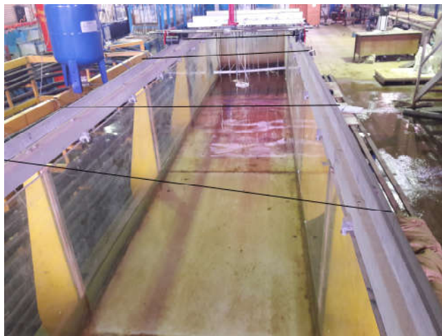
شکل ۱. (رنگی در نسخه الکترونیکی) نمایی از فلوم ۸۰ سانتی متری در حضور سنسورهای اندازه‌گیری غلظت و چهار مقطع اندازه‌گیری
