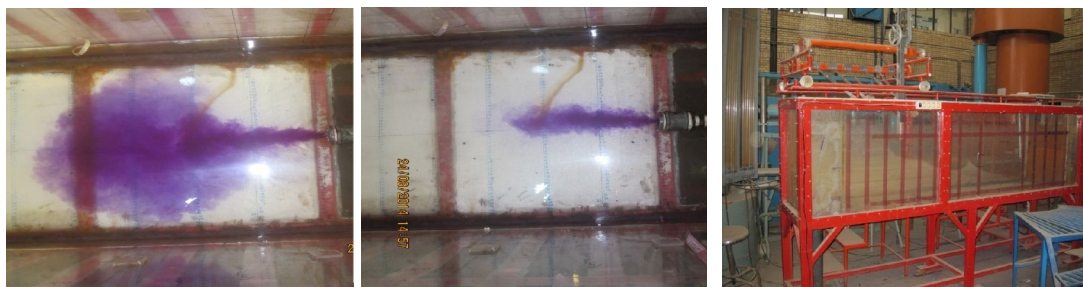
شکل ۲. فلوم آزمایشگاهی و نمونه‌ای از اجرای آزمایش‌ها
