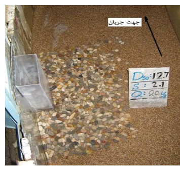
شکل ۴. تکیه گاهها و سنگ چین اطراف آن بعد از آزمایش
