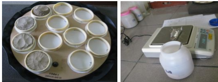
ب) خاک خشک عبوری از الک شماره ۱۰ برای صفحه فشاری ۱۵ بار شکل ۳. صفحات فشاری مورد استفاده در تعیین قابلیت نگهداری آب در خاک
