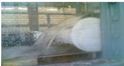
شکل ۱۱. جت پرتابی برای پرتاب‌کننده برای زاویه نصب ۶۰ درجه
