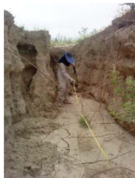
شکل ۲. اندازه‌گیری مقاطع عرضی آبکندها با فواصل ۱۰ متری
