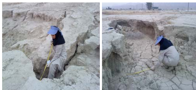
شکل ۳. اندازه‌گیری طول بالا و پایین در آبکندها (عکس سمت راست فداغ، عکس سمت چپ علامرودشت)
