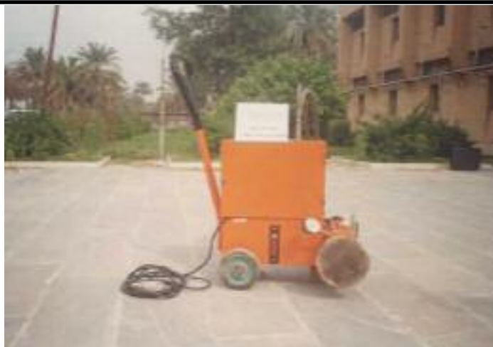
شکل ۴. نمایی از دستگاه مقاومت برشی در محل
