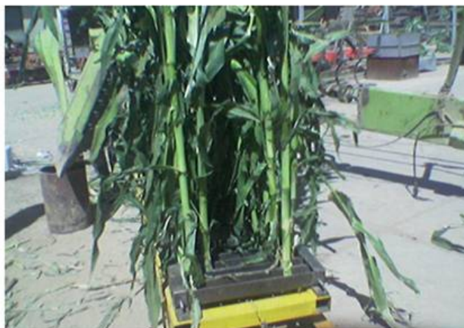
شکل ۶. ریل کالیبراسیون، همان‌طور که در شکل نشان داده شده است دو ردیف ذرت به صورت ایستاده و در شرایطی کاملاً شبیه مزرعه روی ریل قرار گرفته و با سرعتی ثابت وارد دهانه چاپر می‌شود.
