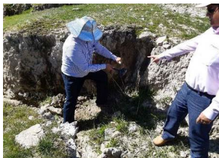
شکل ۳. نمونه‌برداری خاک از پیشانی خندق توسط استوانه فلزی استاندارد
