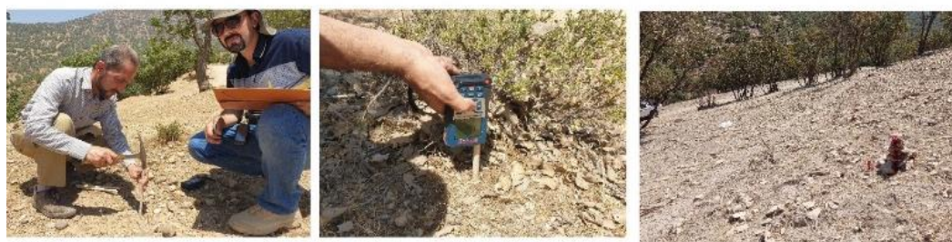
شکل ۲. اندازه‌گیری میدانی فرسایش و رسوب به کمک میخ‌های فرسایشی در منطقه
