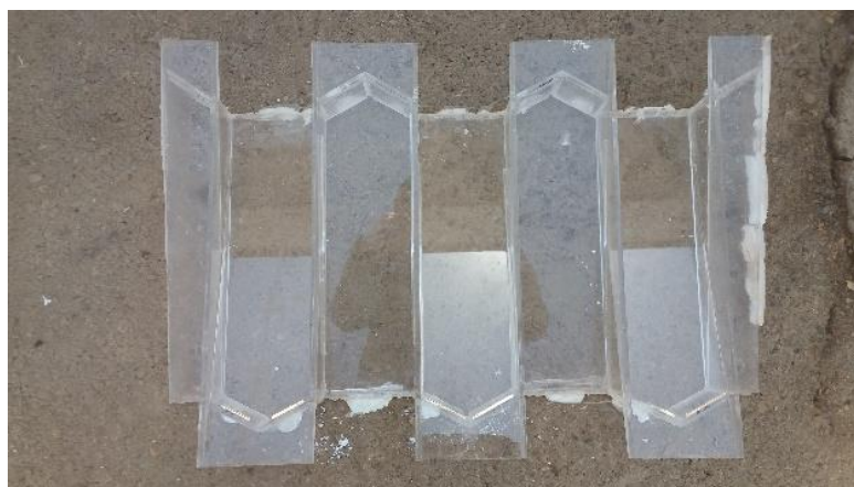
شکل ۵. مدل فیزیکی سرریزهای زیگزاگی مستطیلی و کلیدپیانویی در پژوهش حاضر
