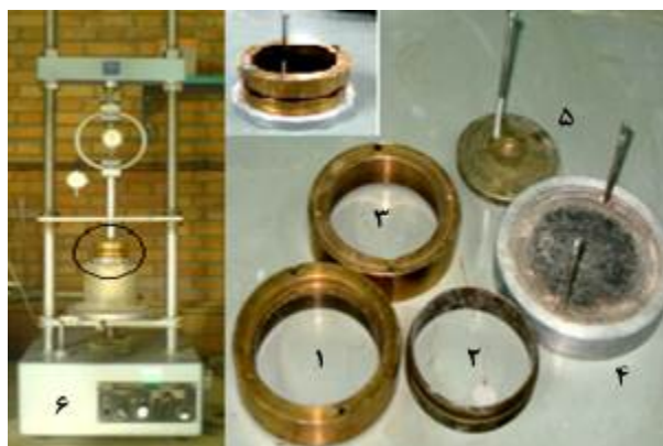
شکل ۱. قالب تراکم مورد استفاده جهت ساخت نمونه‌ها
