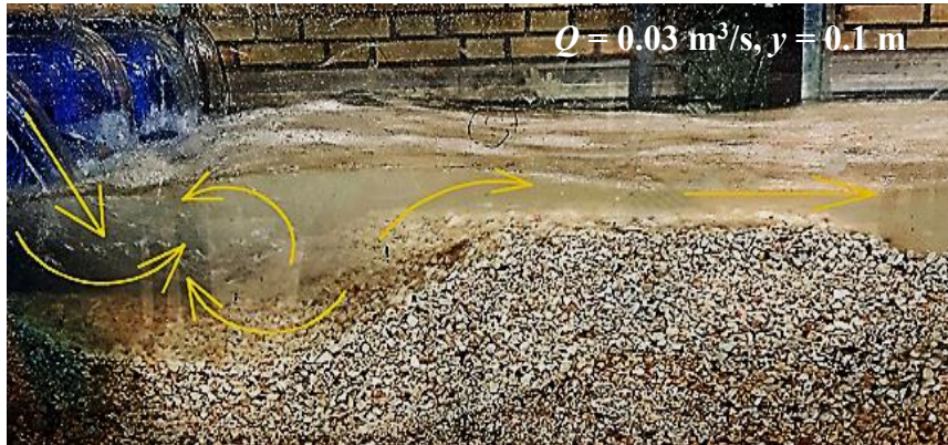
شکل ۴. حفرة آبستگى و گردابه‌هاى موجود در پایین دست سرریز
