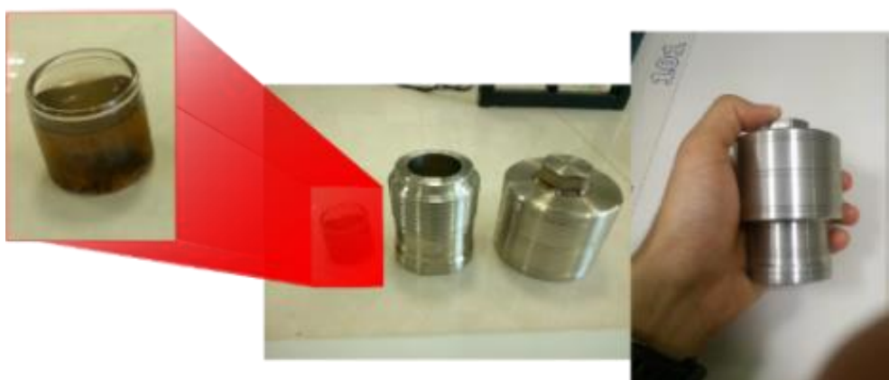
شکل ۲. نمایی از راکتور هیدروترمال و محصول نهایی (سوسپانسیون جاذب میکرومقیاس)
