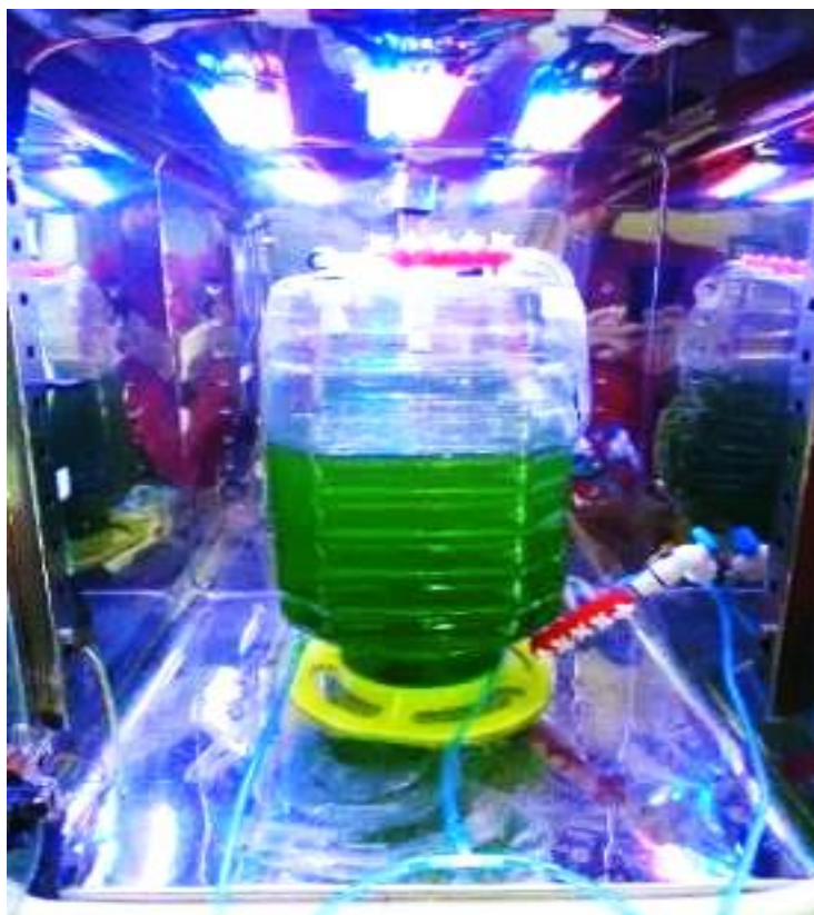
شکل ۱. فراوان سازی سیانوباکتری آفانوکاپسا درون راکتور زیستی قرار گرفته داخل انکوباتور
