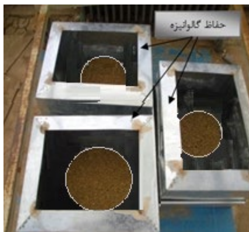
شکل ۲. نمایی از کاسه پاشمان و حفاظ روی آن برای اندازه‌گیری پاشمان زیر دستگاه باران‌ساز
