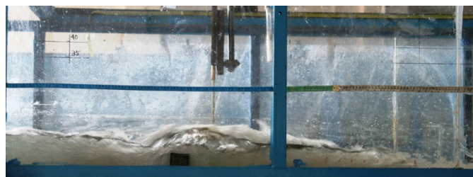
شکل ۵. پرش تثبیت شده توسط آبیایه انتهایی با مقطع عریض مربعی ( L_B = 110\text{cm} و h = 6\text{cm} ، Fr_1 = 4/79 ، Q = 35\text{LPS} )
