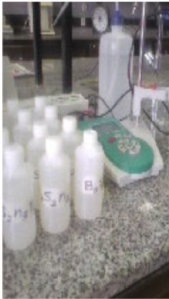
شکل ۷. اندازه‌گیری اسیدیته با دستگاه pH متر
