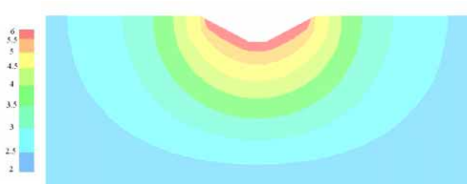
شکل ۱. توزیع پتانسیل فشاری کل (m) در اطراف کانال
