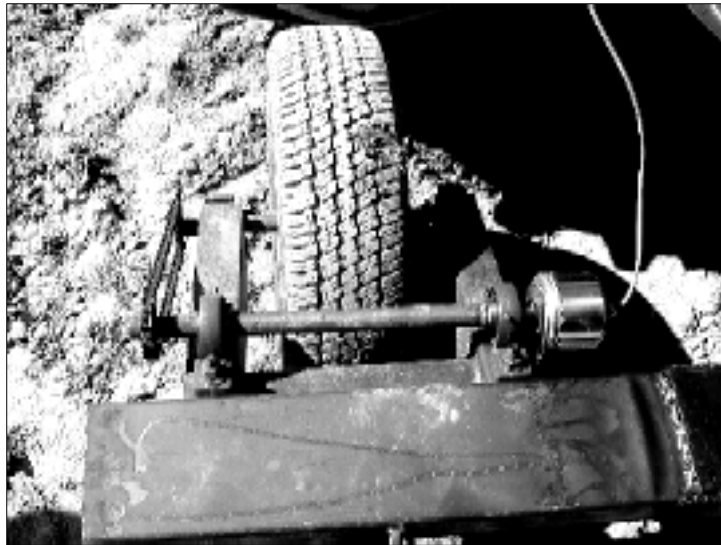
شکل ۷. نمای چرخ پنجم ساخته شده
