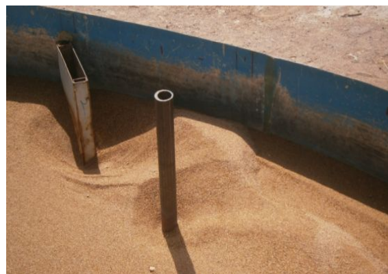
شکل ۸. پایه پل و آبشکن جاذب در دبی ۵۱ لیتر بر ثانیه - الگوی آبشستگی در اطراف پایه و آبشکن
